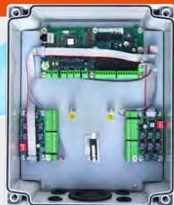
Le MAXIBUS permet de centraliser les contacts d'alarmes des différents produits SORHEA en 1 seul point, grâce à leur mise en réseau. Il possède des fonctions de maintenance et de paramétrage à distance.
