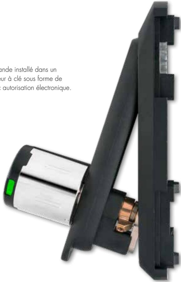
Module de commande installé sous forme de demi-cylindre avec autorisation électronique pour utilisation à l'intérieur avec rappel par ressort et panneton biseauté dans une serrure de serveur avec levier pivotant.
